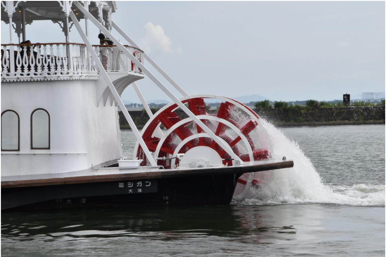
「ミシガン」の外輪。外輪に覆いがないので、パドルが水を掻く様子がよく見られました。
